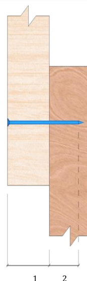
Цвяхове з'єднання з однією площиною зсуву
